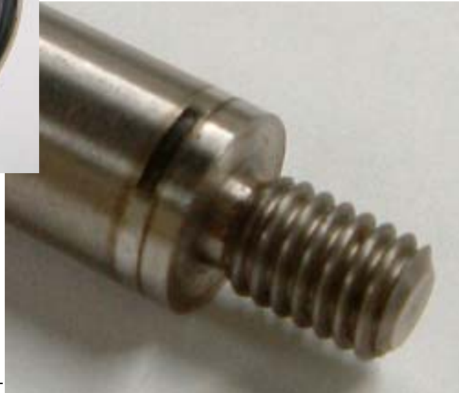
チタンアンテナ端末溶接(t0.22)
