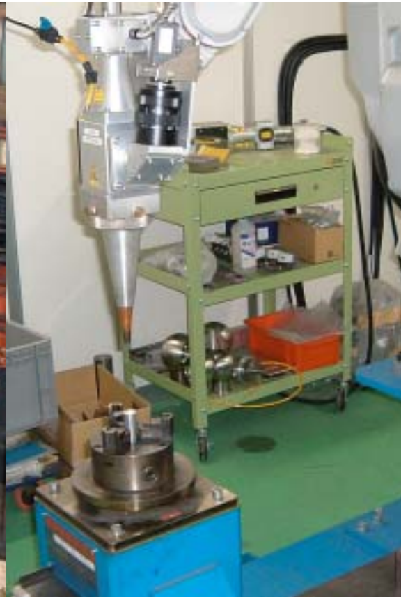
CW 2Kw/ロボット/回転治具
