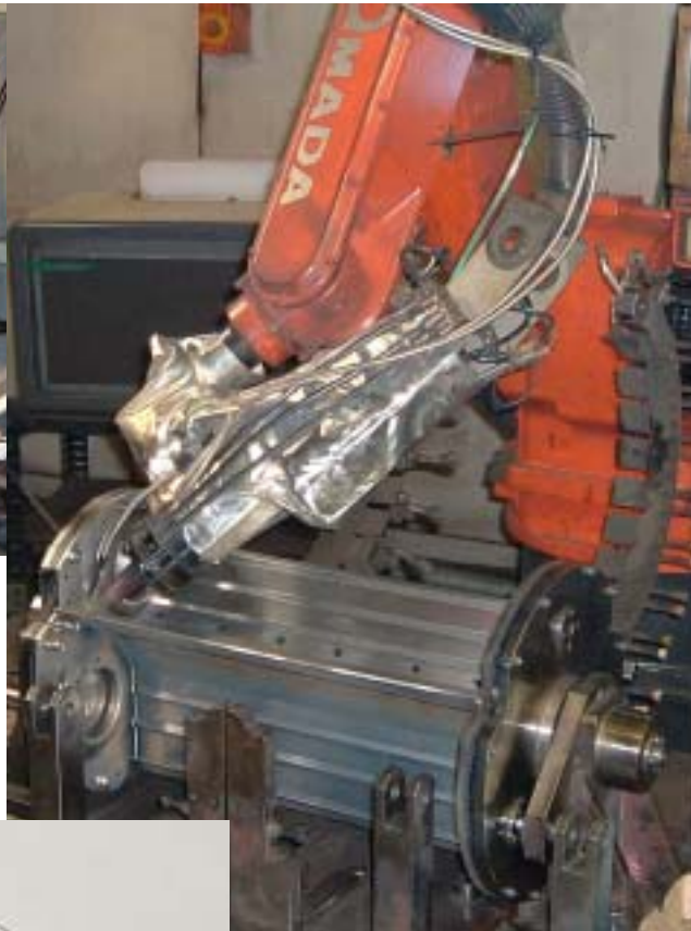
アハックス DPF内部溶接
